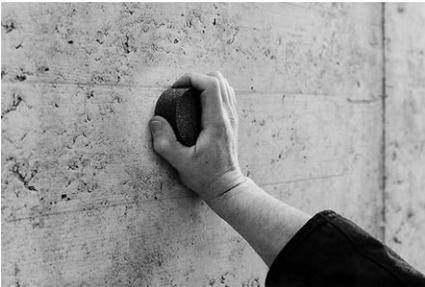
使用打磨石使测试面平滑。使用混凝土回弹仪在这个平滑、坚硬的表面执行几次测试冲击，然后再执行您需要的评估测量。在测试钢砧上执行一致性检查。
