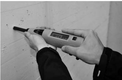
标准中定义了有效的回弹次数所需的测试冲击数。通常，至少为 9 次冲击。各个冲击点之间的距离必须至少为 25 mm。以中等速度朝测试面方向推动混凝土回弹仪，直至触发冲击。
